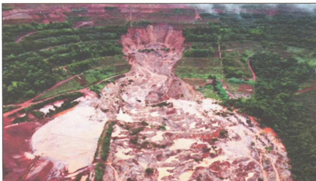
Figura 09 - Deslizamento da Pilha Cachoeirinha da Vallourec. Fonte: Fórum Permanente do São Francisco
