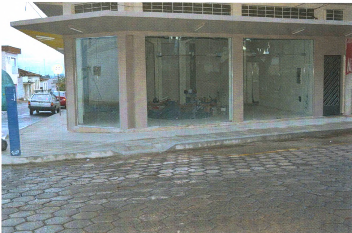
Imóvel comercial sem rampas de acesso, rampa na calçada com inclinação muito elevada (Praça do Rosário)
